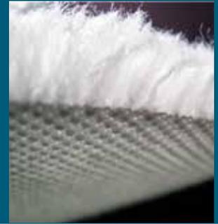
Le tissu recouvrant les tambours et les disques filtrants est du type « polstoff » ou « à fibre libre ».
