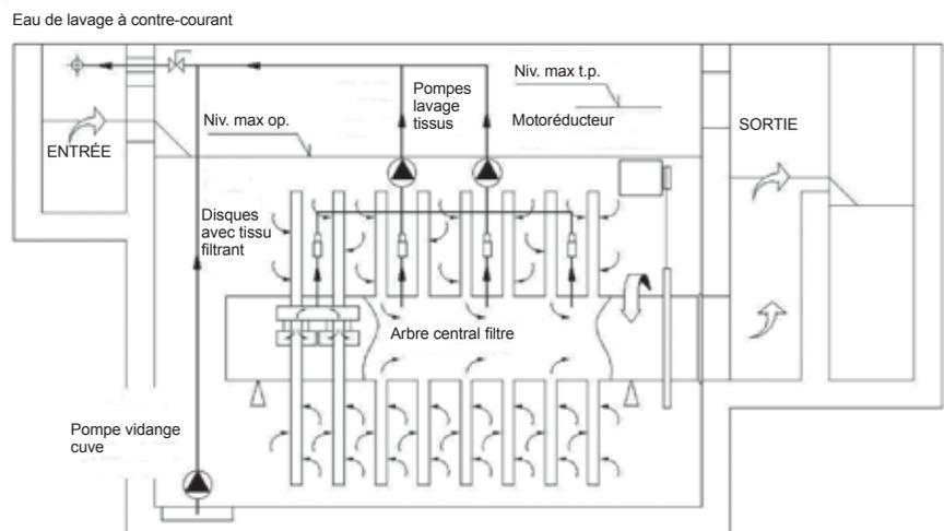
Schéma typique du filtre MITA à disques
